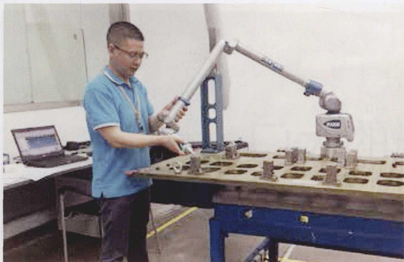
图2 工作人员正在操作 FaroArm 测量臂
