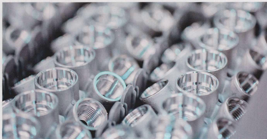
图 2 钻孔精度 H7 公差是展示其精度的一个实例，加工精度可达 0.000 55 in (14 μm)
