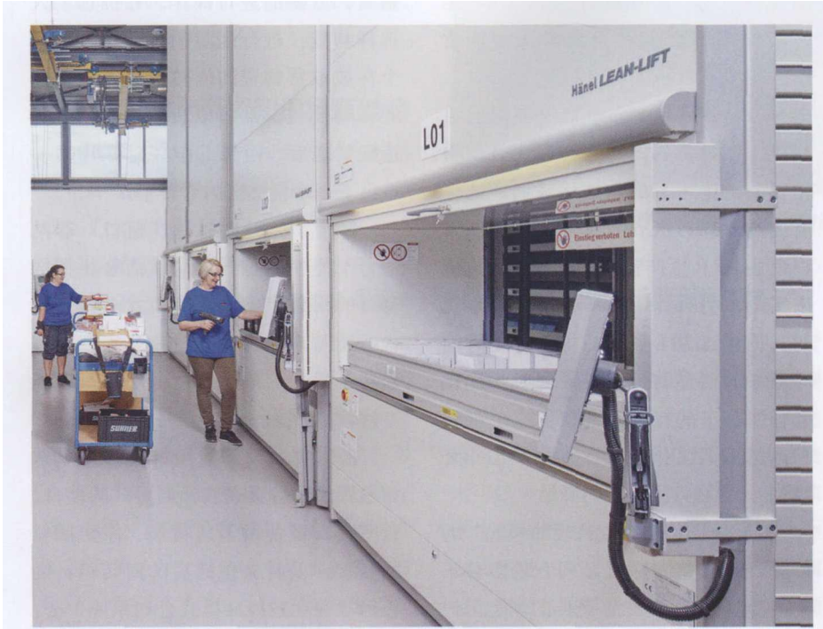
图 1 每个仓库升降机最多可以存放 56 个集装箱的物资，成品零件、磨削刀具和各种用户所需的小型零件和装配用物品都存放在这些大型周转箱中
