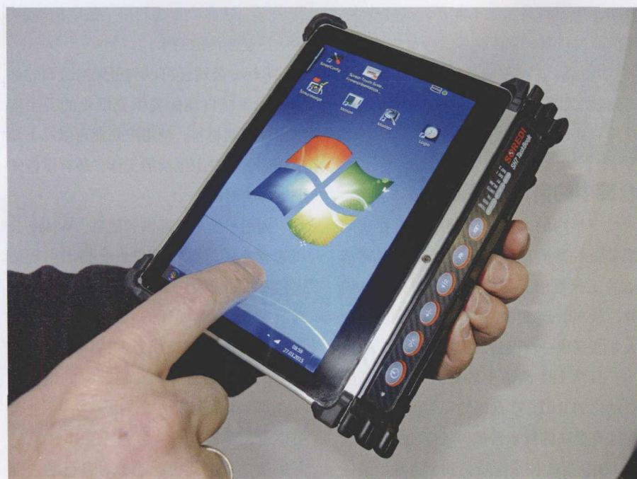
图 2 带有功能键栏的 SH7, 每个员工都可以设置自己的按键功能
