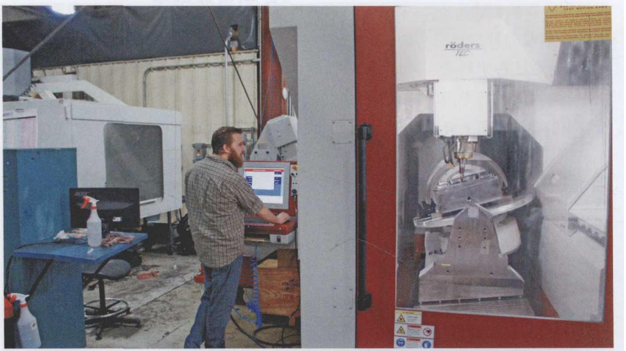
图 1 除其他优势外，Precise Tooling Solutions 公司的 Roeders RXU 1001 DSH 五轴机床的精度还能通过降低电火花加工和抛光需求提高多元性和效率。这项技术投资基于持续性的数据收集和分析
