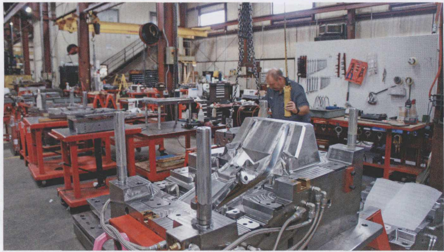
图3 通过共享综合汽车照明和内饰模具，该厂每年可加工 35 ~ 100 个新注塑模具，同时可以维修 / 修改 300 ~ 350 个模具。该厂生产的新模具的重量大部分介于 200 ~ 750t 之间，但是该厂所维修的模具重量通常更大
