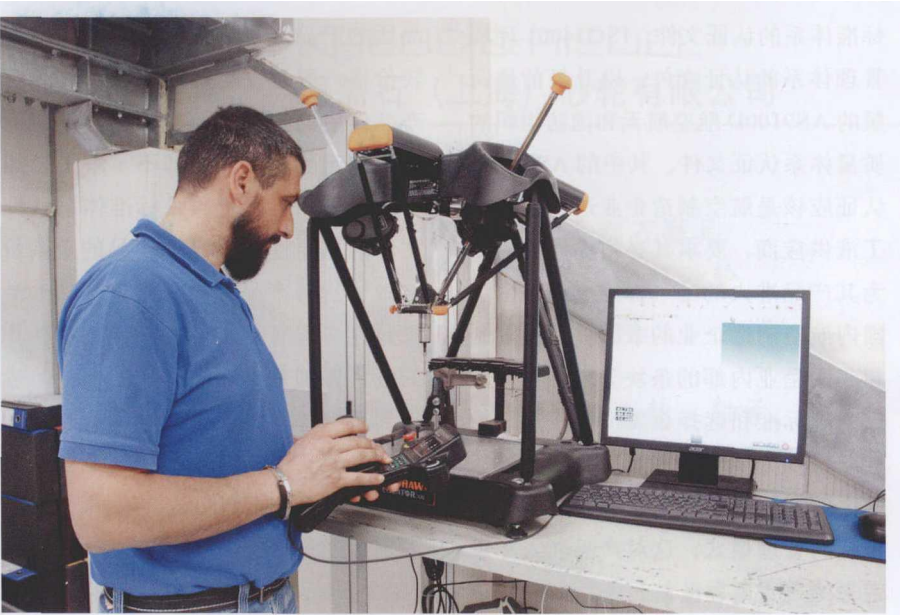
图 2 Maurizio Rullo 正在使用 Equator 比对仪
