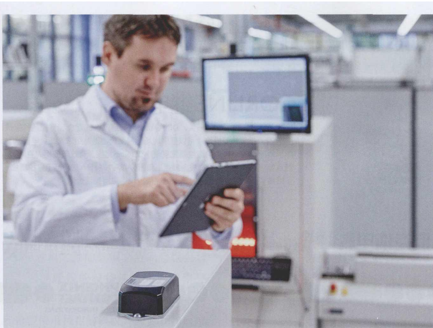
图 1 移动设备可通过紧凑型无线电模块 / 接入点 FL WLAN 1100 接入数据网络
