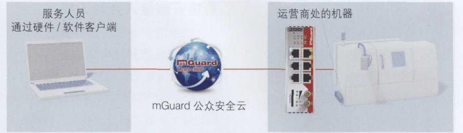
图 2 借助 Mguard Secure Cloud 可以实现机器和设备的安全远程维护
