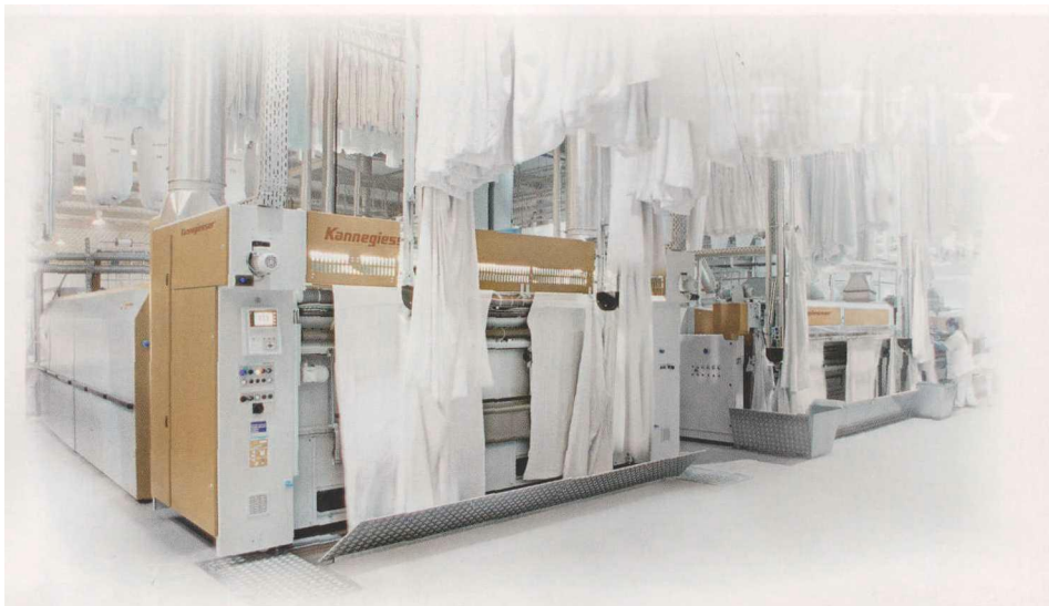
图 1 工业洗衣店中的整烫段可以在每小时自动输入 2400 件的情况下，熨平、摺叠和码放床单和被套，过程技术必需的程序和件数信息与物流同步
