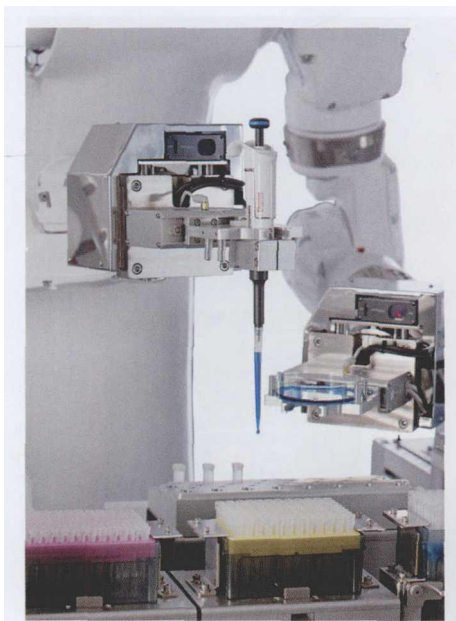
图6 双臂机器人 Motoman CSDA10F 可以精确和准确再现地完成生物、化学以及医学实验室的工作
