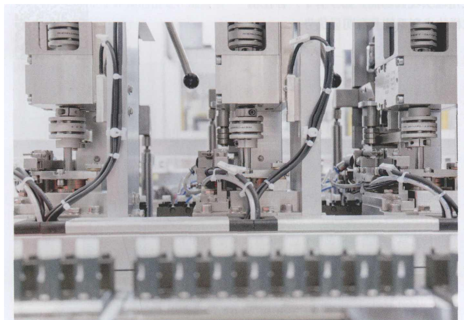
图7 PIA 公司开发和制造装配自动化系统，如旋转分度系统、长传输系统、特殊装备和机器人单元。图中所示为柳叶刀组装”
