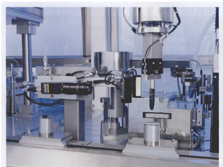
图 2 注射器插管的摄像检测
