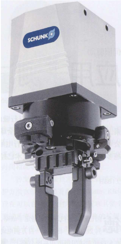
图 3 全球最紧凑的电动抓取旋转模块 SCHUNK EGS 可提供尺寸 25 和 40，夹持力为 15N 或 140N，行程为 3mm 或 6mm，适用于重量最高为 0.55kg 的部件
