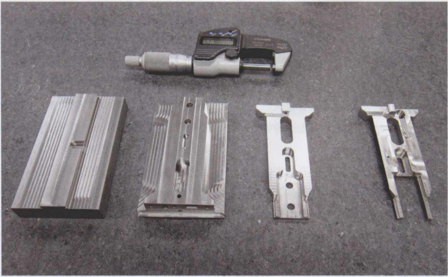
图 3 该零件要求沿着每一侧长度的平整度为 \pm 0.001\text{in} ，当跨越多个 VMC 运行时，这会导致废品率达 30%。今天，在机床厂 HMC 之一上进行 3+2 加工，已经将废品率降低到几乎为零，同时提高了产量，这是因为可以同时固定 4 个零件
