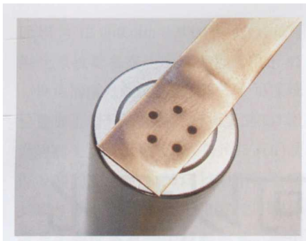
图2 激光打标机的功能不仅仅是打标，光纤激光打标机可将此铜质标签焊接在 18650 容器上，该设备同样可用于精密切割
