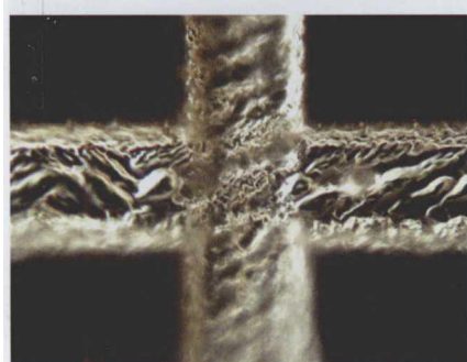
图4 上图金属箔管的近图。高级技术经理 Geoff Shannon 说：“激光显微机械加工中心是对当今这一行业内许多单位较为恰当的称呼。”
