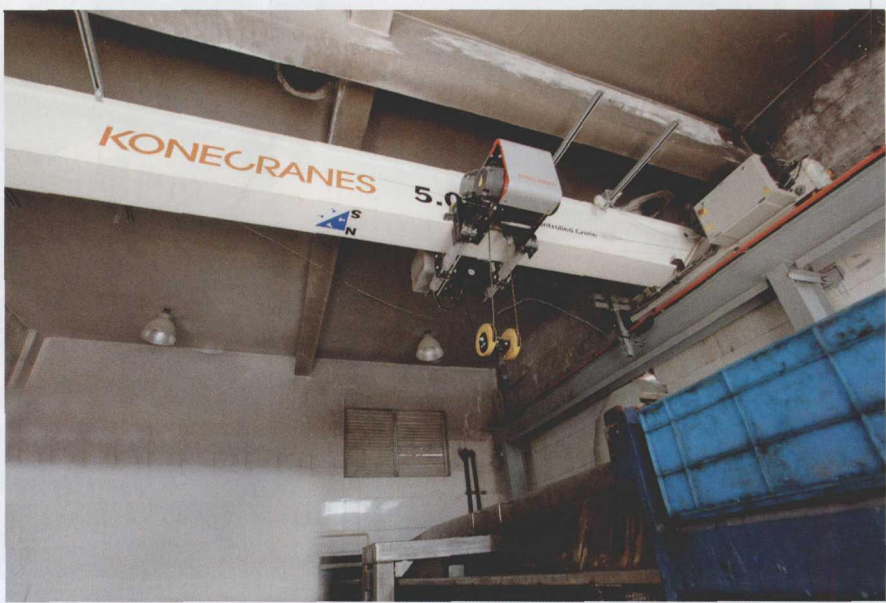
图 1 安装在产品检测区域的最新款科尼 CXT 标准型起重机
