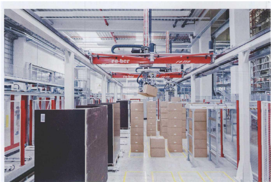
图 1 工作中的龙门式机器人：在自动化技术的帮助下能够在很短的时间内完成许多数量很少的订单
