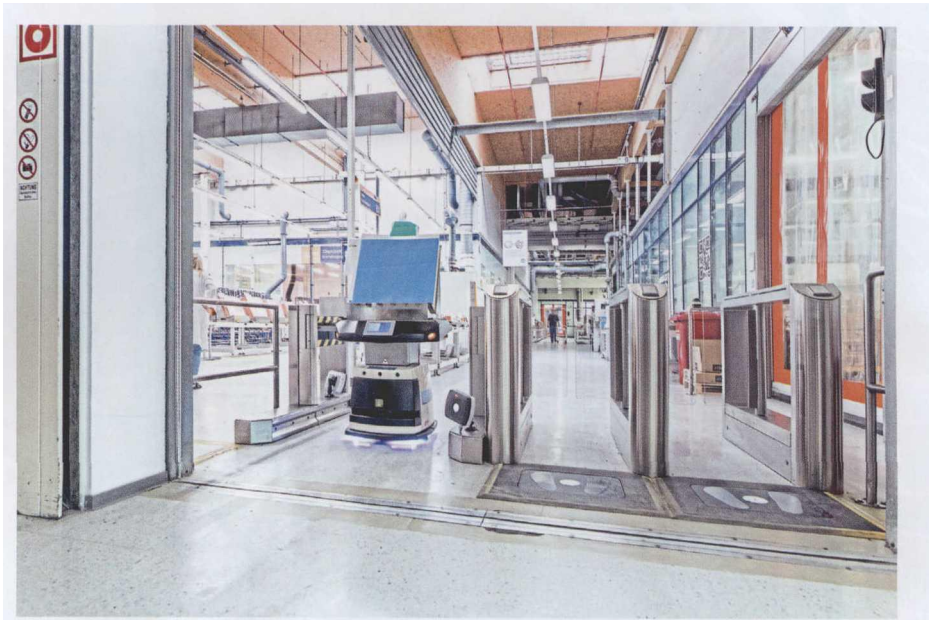
图 3 车间入口处的人员隔离装置提高了安全性，这也要求 FTS 无人驾驶运输车能够与人员隔离装置的控制系統保持通讯
