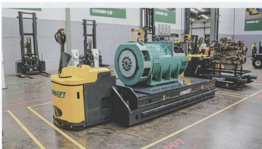
图 Combi-HC-PPT 型托盘叉车的载重量为 3~6 t，可以根据用户的要求专门定制最大载重量 7~16 t 的托盘叉车
