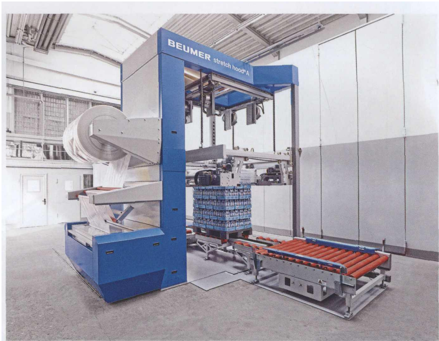
图 2 新型的 stretch hood A 型包装设备可以简单的实现个性化操作，占地面积减少了 40%
