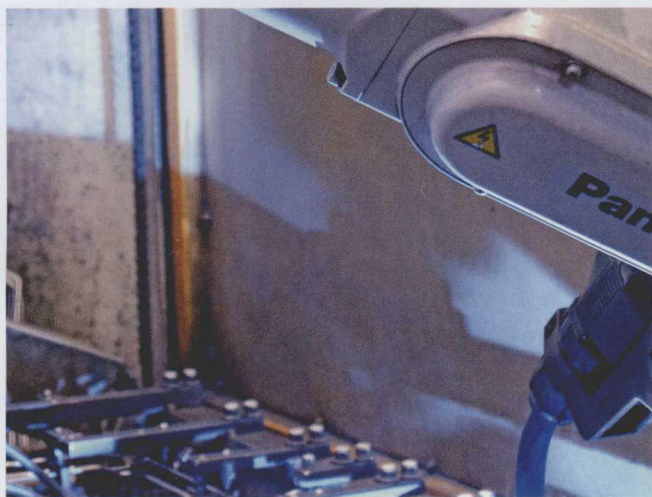
图2 TA 1400 型 SP-MAG 焊接机器人增加了一位新成员，那就是工作活动范围为 1600 mm 的 TM 系列焊接机器人，它的送丝管和电源电缆都集成在焊接机器人的手臂内部
