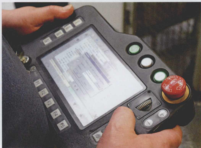
图3 利用松下提供的手持式编程器可以方便的编写 SP-MAG 焊接机器人的焊接加工程序
