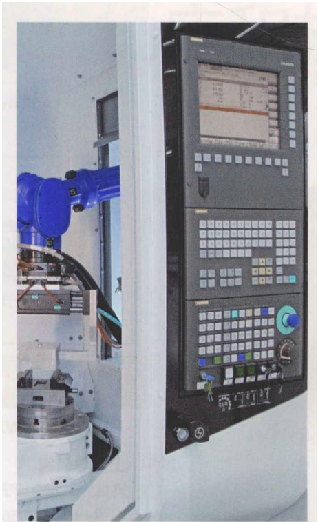
图3 在 Sinumerik 的 CNC 数控程序中集成了机器人机械运动程序段之后，既提高了生产能力又提高了切削加工机床的灵活性，能够加工出最高精度和质量的零件
