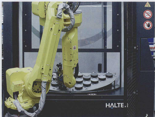
图2 毛坯的供给和成品的下料都由回转工作台中的机器人来完成，加工开始前它将毛坯从缓冲库托盘上拿起来、放入机床
