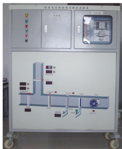
图2 全空气空调控制与模拟实验台
