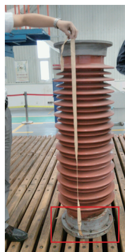
图10 224-9 C相CVT上节耦合电容器油位对比
