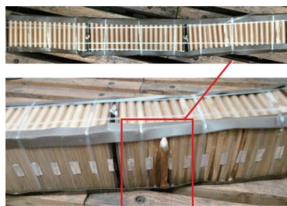
图11 224-9 C相CVT上节内部电容器组
