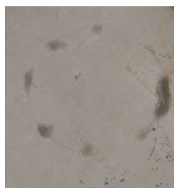
图4 上节耦合电容器 放置位置油迹
