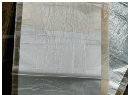
图13 224-9 C相CVT电容元件无放电灼烧痕迹
