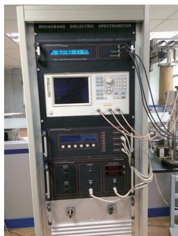
图2 宽介电谱测试系统Concept80装置图
