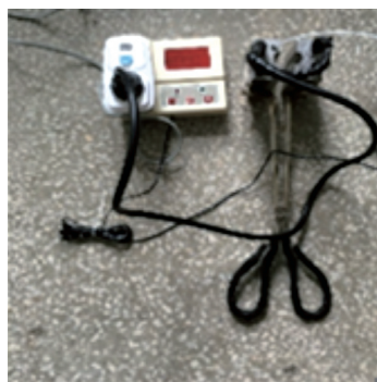
图8 专用自加热热缩带包扎模具模型图
