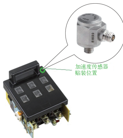
图2 加速度传感器及其贴装位置
