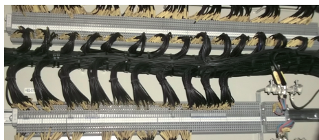
图3 机车控制电路电压端子排
