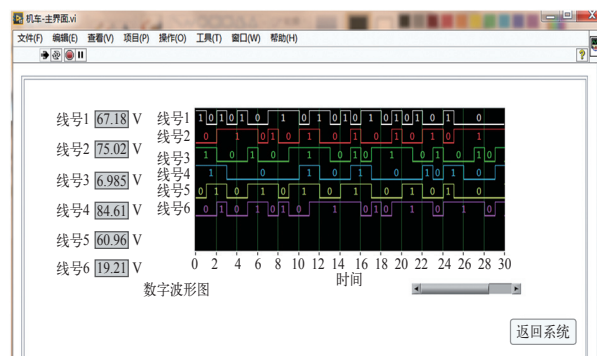
图8 测试系统电压数字波形
