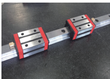
图8 单根滚动直线导轨副
