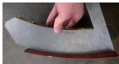
图6 小弯梁最终压型尺寸
