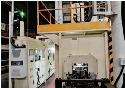
图2 多工位缸孔珩磨自动线
