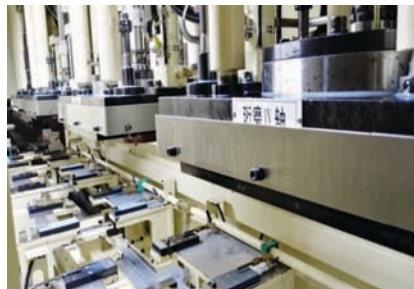
图3 DHK037珩磨机有4个轴、6个工位
