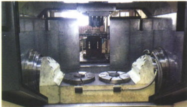
图11 摇篮式摆动轴和双转台结构
