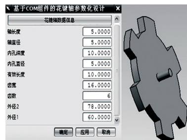
图10 反馈2号数据条所生成的花键轴
