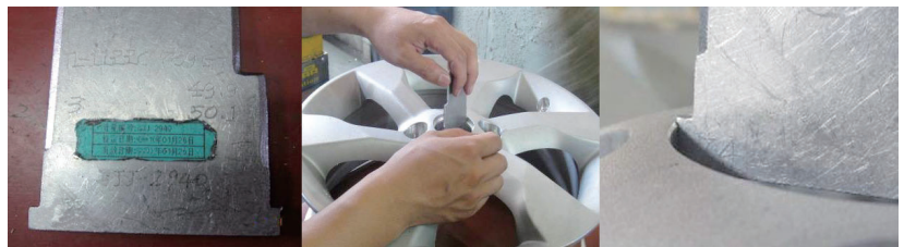
图5 帽槽深度检测
