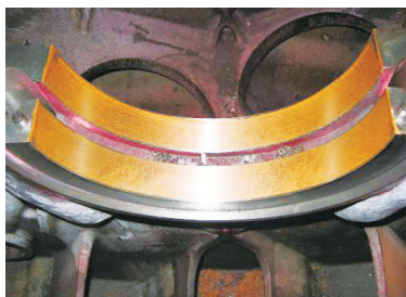
图8 压瓦后的机体主轴承座孔
