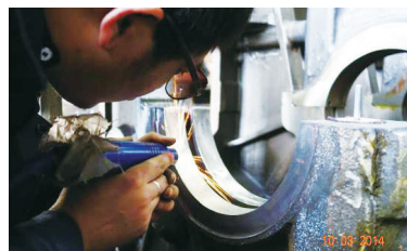
图4 微电弧火花堆焊作业中
