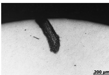
图4 开裂螺栓横截面形貌
