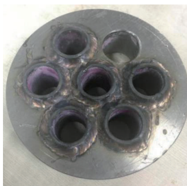
图2 管板焊后实物
