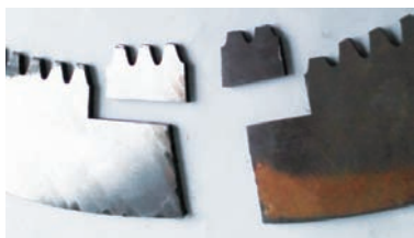
图4 摩擦片芯板材质化验取样
