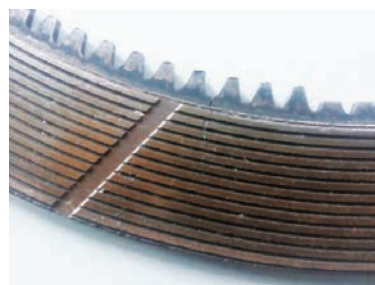
图3 摩擦片裂纹源
