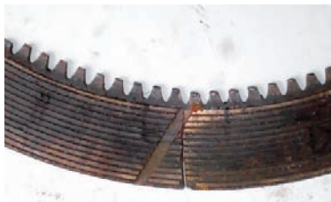
图1 摩擦片断裂形式
