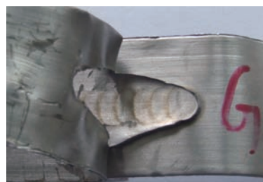
图3 焊接接头撕破外观形貌
