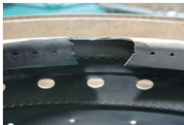
图2 双重环裂纹、掉块缺陷
