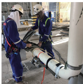
图1 射线检测操作人员正在进行小区域射线曝光检测操作
