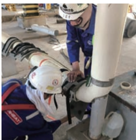
图1 射线检测操作人员正在进行小区域射线曝光检测操作
