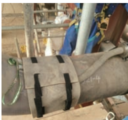
图3 将电离辐射屏蔽材料包裹在射线底片与放射源出口外侧
