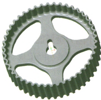
图1 粉末冶金凸轮轴正时齿轮三维模型
