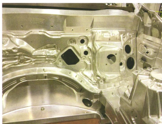
图2 防火墙区域供管线穿过的众多孔洞
