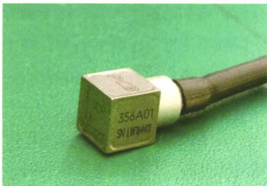
图3 发动机固定加速度传感器
