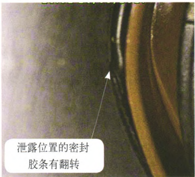
图4 通过内窥镜发现的泄露点
