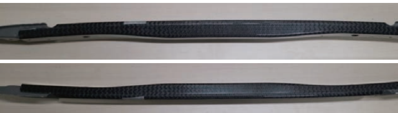
图3 三维编织CFRP车顶横梁样件
