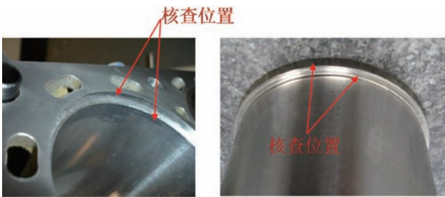
图2 缸孔止口处的圆角及倒角尺寸核查
