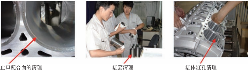
图8 缸套、缸孔及其配合表面清理
