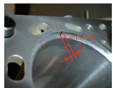
图6 止口高度尺寸示意
