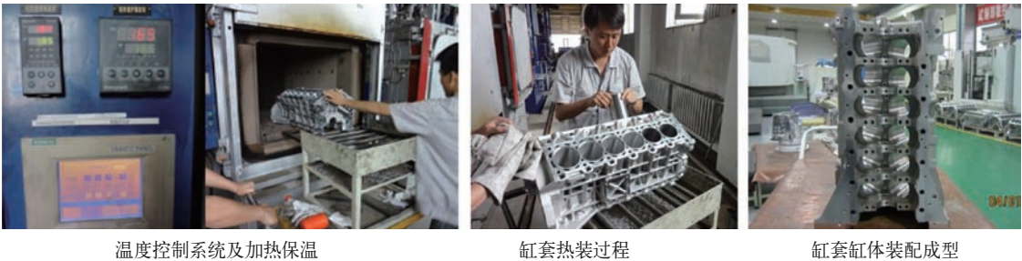
图7 改进后的热装过程实例
