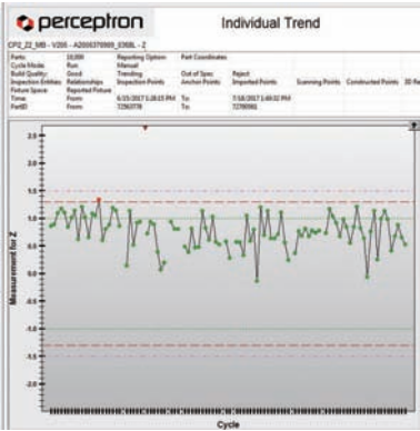
图6 左侧5号焊钉Z向测量结果图
