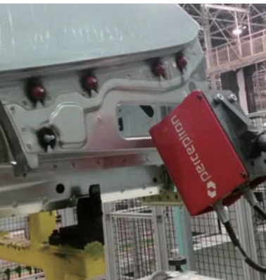
图5 机器人自动检测焊钉位置尺寸
