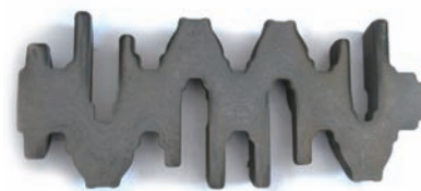
图3 曲轴的锻造流线（经过感应热处理后）
