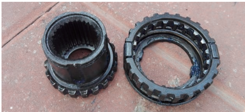
图1 自动锁止器产生异响零件
