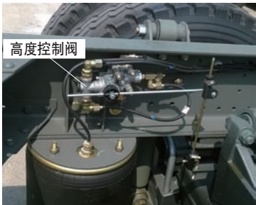
图3 高度控制阀安装示意
