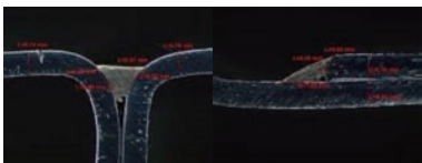
图8 激光钎焊焊缝 a 值低缺陷
