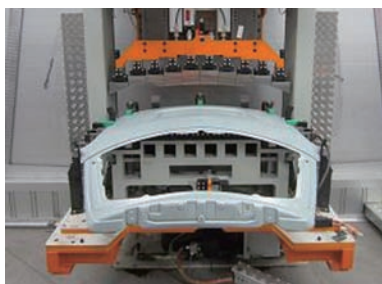
图4 GLK举升门激光钎焊现场图
