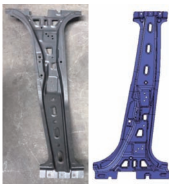
图7 B柱加强板产品件与三维数据
