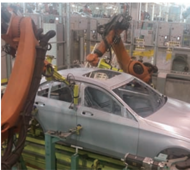
图2 间隙平顺测量设备（SMA）
