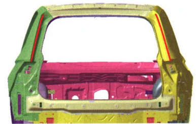
图2 落水槽激光钎焊
